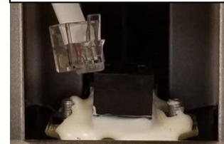
Câble de cellule de pesage non connecté
