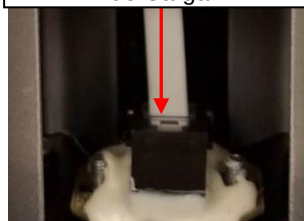
Cable de la Celda de Carga
